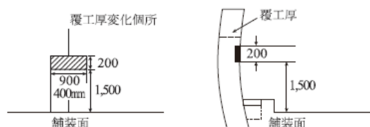
図10-6-1 覆工厚変化箇所の刻示標準図
